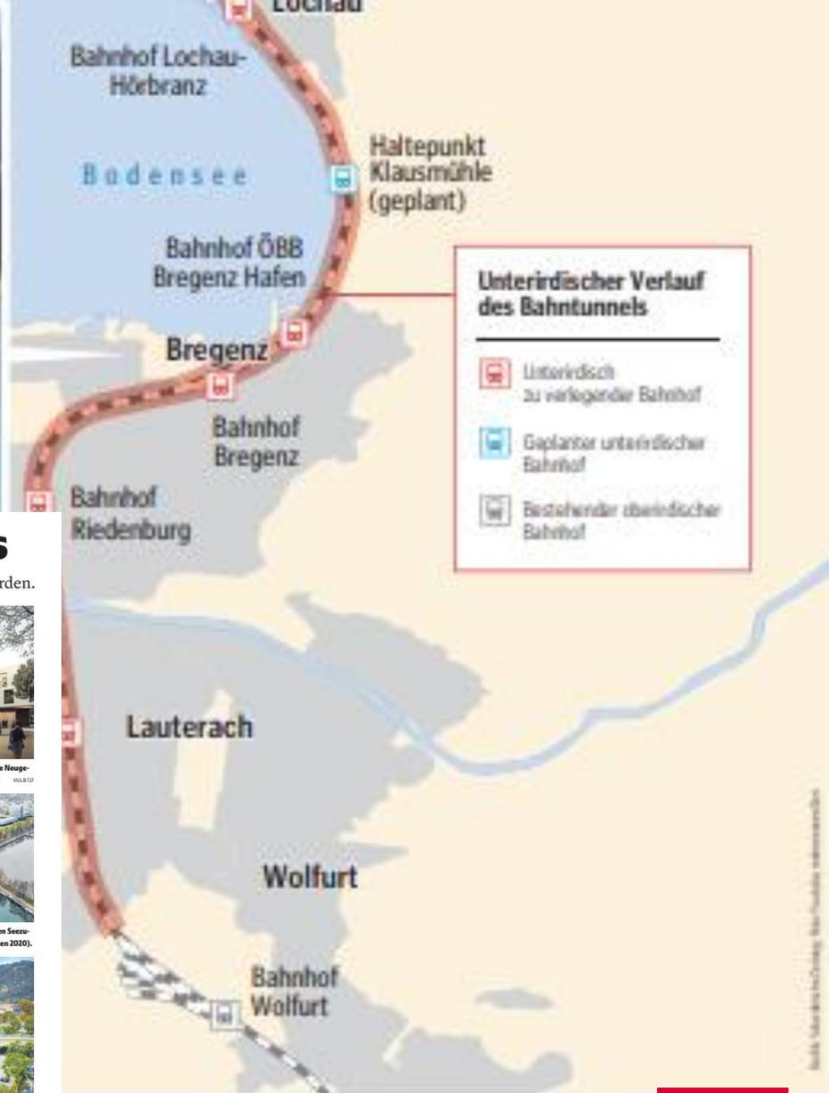
**Unterirdischer Verlauf des Bahntunnels**
