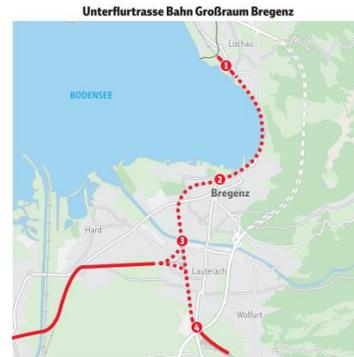
1. Brücke bei der Leiblach in Lochau: 2-gleisige Bahntrasse geht in die Tiefe und wird ca. 10 Meter unter der Oberfläche geführt.
